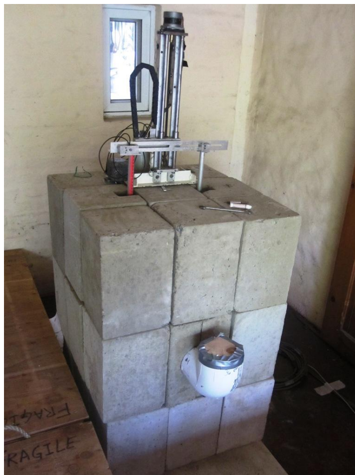
Figura 6. Disposición experimental. Una de las vainas medidas se encuentra inserta en el centro del conjunto de bloques de hormigón. El sistema THATIR se encuentra sobre la cara superior del conjunto. La fuente y el detector están en el extremo inferior de sendos tubos que se deslizan hacia abajo y que en la foto se los ve cerca del final de su recorrido.
