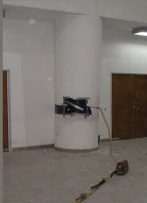
|| Gamagrafiado de una viga. El equipamiento portátil permite estudiar estructuras en altura o de difícil acceso.
