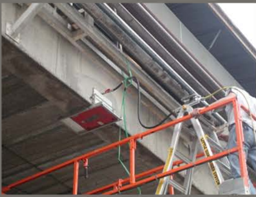
|| Gamagrafiado de una viga. El equipamiento portátil permite estudiar estructuras en altura o de difícil acceso.
